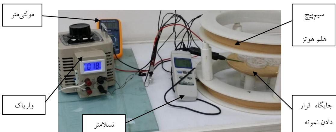
شکل ۱- سامانه اعمال میدان مغناطیسی متناوب به بذر چمن
